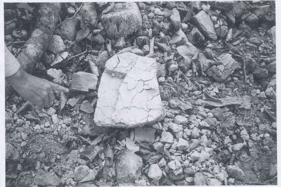
写真 4.1.5 風化の進んだシルト岩の一片([21]地点。薄片状に剥がれやすい。) A piece of weathered silty rock (Point [21])
