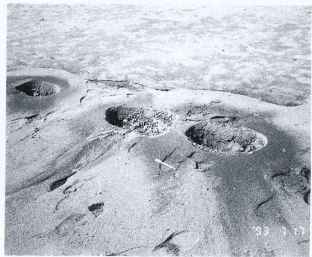
写真 4.10.3 中ノ沢小学校校庭の噴砂口 Sand volcanos spotting the Nakanosawa elementary school grounds
