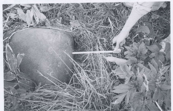
写真 4.3.11 移動したとみられる玉石 左岸兜野橋下流, 堤外地 Moved cobble(Shiribeshitoshibetsu river)
